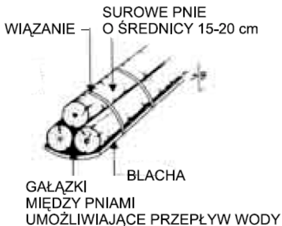
Ryc. 18. „Dreny” z kłód (pni) umożliwiające przepływ wody.
