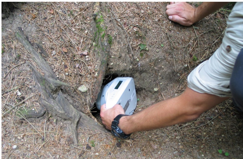
Fot. 3. Pobieranie powietrza z nory (fot. K. Patejuk). Photo 3. Air collecting from the burrow (photo by K. Patejuk).
