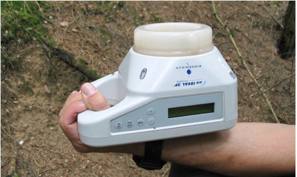
Fot. 2. Aparat Air Ideal 3P wykorzystywany do badań aeromycologicznych (fot. K. Patejuk). Photo 2. Air Ideal 3P – equipment used in aeromycological research (photo by K. Patejuk).
