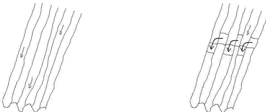
Ryc. 7. Zabudowa rynien erozyjnych materiałem z ich krawędzi
